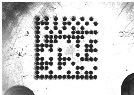
그림 4-3 도트 피닝 기법을 사용한 GS1 DataMatrix 심볼
