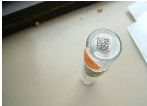
그림 4-2 레이저 기법을 사용한 GS1 DataMatrix 심볼
