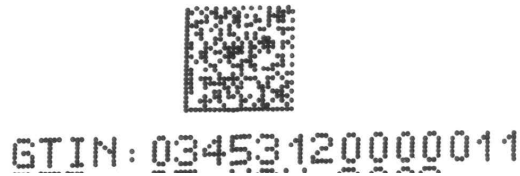
그림 4-1 잉크젯 방식으로 인쇄한 GS1 DataMatrix
